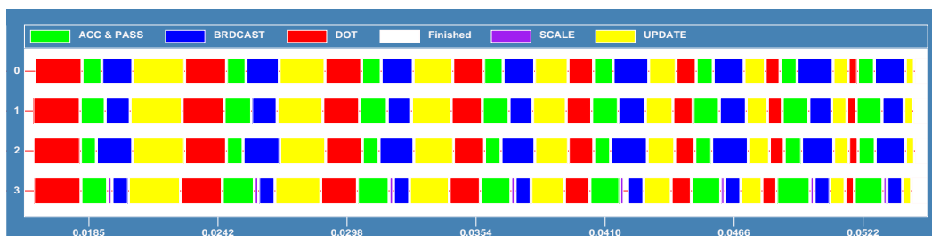
(d) Row-brdc partitioning applied to a 320x8 matrix.
